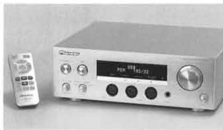
(主な仕様) ●デジタル入力:USB(Type B)×1、RCA×2、XLR×1、TOS×2 ●アナログ出力:ヘッドフォン×3(6.3φ標準、3ピン型バランスXLR、4ピン型バランスXLR各1)、RCA×1、XLR×1 ●出力(32Ω):180mW+180mW(6.3φ標準)、300mW+300mW(バランスXLR3/XLR4) ●対応インピーダンス:160~600Ω ●周波数特性:4Hz~80kHz(-3dB) ●SN比(A-Weight):106dB(6.3φ標準)、113dB(バランスXLR3/XLR4) ●大きさ:296W×101H×271Dmm ●重さ:6.3kg ●問い合わせ先:パイオニア カスタマーサポートセンター ☎0120-944-222、044-572-8102
