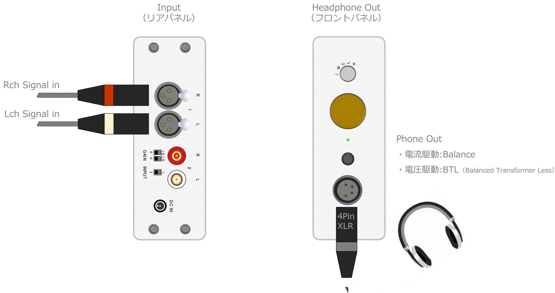
電流駆動 : Single及びBalance接続において駆動電流、パワーとも同じ
